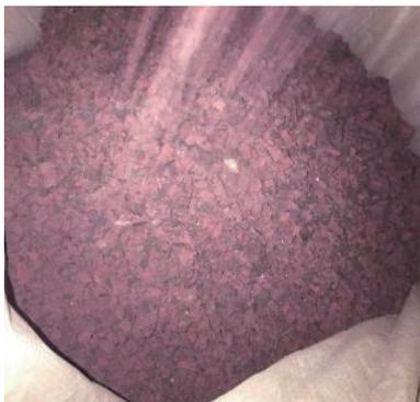
经热泵带式污泥干化机处理的漆渣
